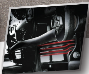
ช่วงล่างพลาโบบิกที่หนบแน่นชื้อน เหมาะกับการใช้งานบรรทุก รองรับน้ำหนักได้ 13 ตัน
