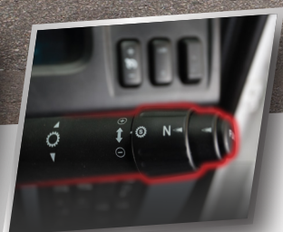
ชุดเกียร์ G330 แบบพาวเวอร์ชิฟ (เดินหน้า 12 กอຍหลัง 2) รองรับแรงบิดได้สูงสุดที่ 3,300 นิวตัน-เมตร
